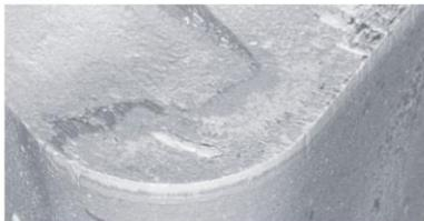
キーテクノロジー：硬質なTiCN被膜の適用とTiCN膜の柱状晶化により高い耐摩耗性を付与
