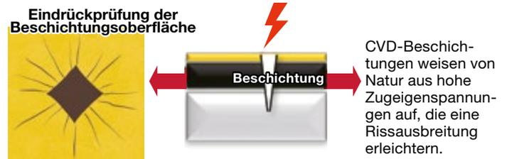
**Die PremiumTec-Technologie verbessert sowohl die Glätte als auch die Zähigkeit der Beschichtungsoberfläche und erhöht die Widerstandsfähigkeit gegen Ausbrüche, Aufbauschneiden und Brüche.**
