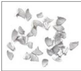
Aluminiumlegierungsguss (EN AC-46100)
