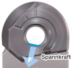
Durch den flachen Bereich der Schraubenöffnung wird die Spannkraft beim Spannen in die Richtung des Fräskörpers gelenkt, was eine hohe Wiederholgenauigkeit und Stabilität sowie einen präzisen Rundlauf ermöglicht.
