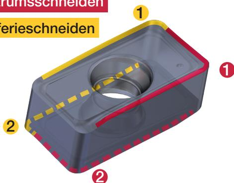
Eine einzelne Wendescheidplatte kann entweder als Zentrumsschneide oder als Periferieschneide verwendet werden und kann in jeder Position zweimal eingesetzt werden – **vier Schneidkanten für höchste Wirtschaftlichkeit der WSP.**
