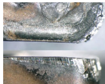
逃げ面摩耗が進行。更に微小なチップング、溶着が発生。
