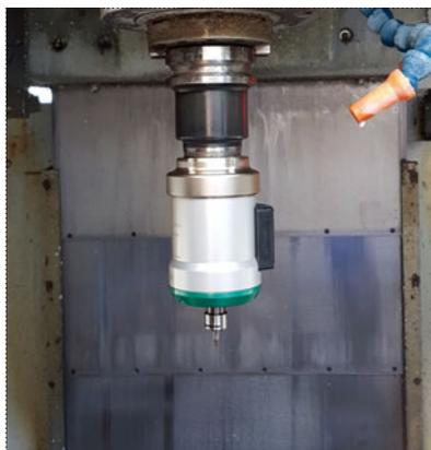
図28 機械へのスピンジェット取り付け状態
