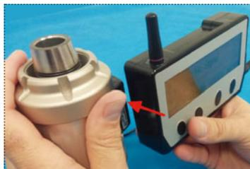
図13b ディスプレイの回転数検出側と送信機をスライドさせる
