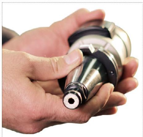
図30 クーラントスルー方式ツールホルダの例
