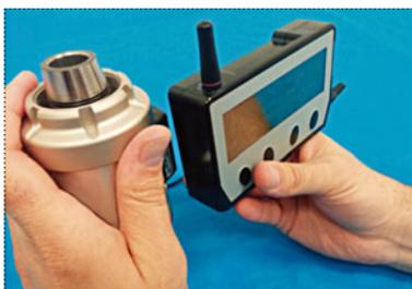
切断が完了すると、該当する識別番号と「Disconnected」の表示に変わり、バッテリー残量が確認できます。表示されている識別番号がワイヤレス送信機のもものと合致していることを確認して下さい。(図19)
