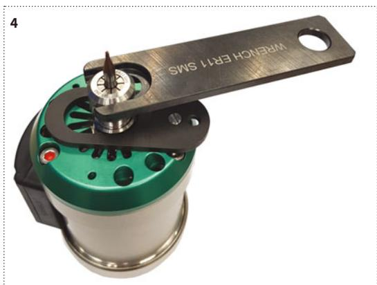
図35 スパナをナットの溝に差し込み、時計回りに回転する
