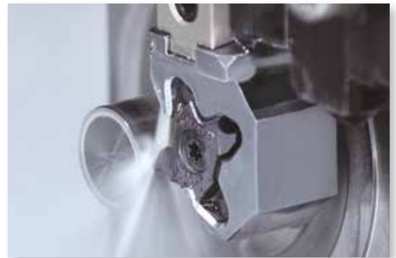
Todos los cabezales están disponibles con suministro de refrigerante a alta presión
