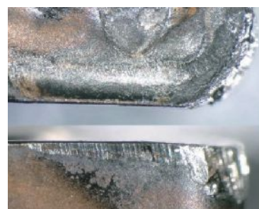
后刀面磨损加剧会导致微小崩刃和积屑瘤
