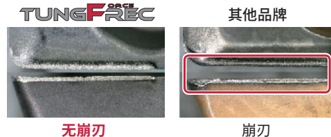
在加工时间相同的情况下切削刃磨损对比
