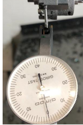
❸ 使用杠杆表检查磨削面在主轴箱和机床上的平行度
