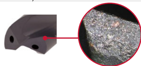
Krawędź skrawająca monolitycznego wiertła węglikowego (po przeostrzeniu)
