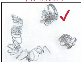
STX 刀片 (有断屑槽)
