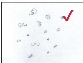
STX 刀片 (有断屑槽)
