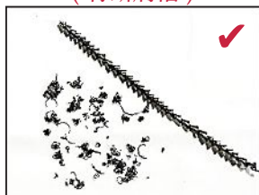
STX 刀片 (有断屑槽)
