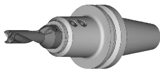
用于在铣床上调整孔径的刻度 (套筒外围)
