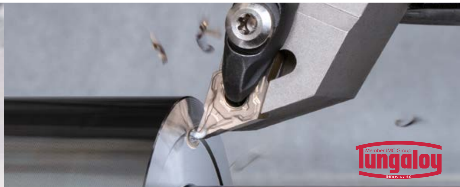
GNMG0904 destička s úhlem špičky 70°: dobrá alternativa k destičkám CNMG s úhlem špičky 80°
