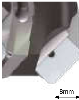
Fresa convencional 4 aristas de corte
