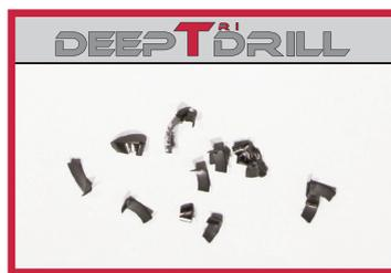
Schnittgeschwindigkeit: Vc = 100 m/min
