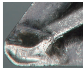
รอยบวม (crater wear) จากการสึกหรอ ที่มากเกินไปจากการเจ้าน้ำหล่อเย็น ภายนอก (ที่ความดันปกติ)
