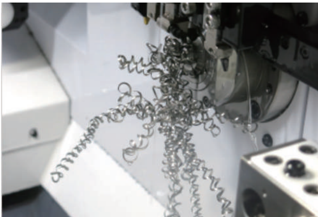
หัวฉีดน้ำหล่อเย็นภายนอกที่แรงดันปกติ
