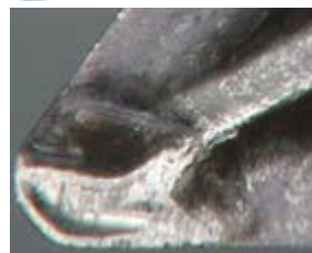
Nadměrné opotřebení (kráter) s externím přívodem chladicí kapaliny (normální tlak)
