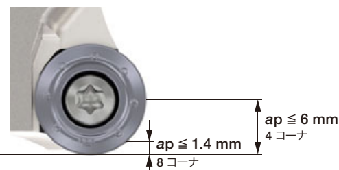
RQMT1204ENC8-MM 1.4 mm 以下の切込みで 8 コーナ、 6 mm 以下の切込みでは 4 コーナ使用可能
