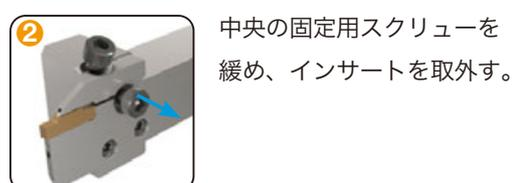
斜め挿入用インサートのみを外しても、インサートが取外せない場合があります。
