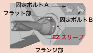
ドリルのフランジ部にあるフラット面の中心に、「EZスリーブ」端面側の目盛りを合わせます。
