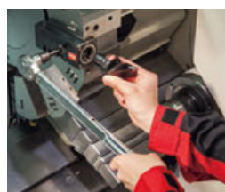
短時間で工具を交換
