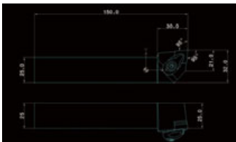
旋削工具: 基準コーナ R を備えたインサートを表示しています。
