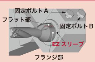
ドリルのフランジ部にあるフラット面の中心に、「EZ スリーブ」端面側の目盛りを合わせます。右図は、ドリルの芯が + 方向に 0.1mm 移動するようにセットしています。
