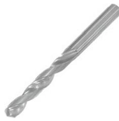
ソリッドドリル、先端角130°、油穴なし、シャンク径 = 工具径、L/D = 3、工具径 ø3 - ø20 mm
