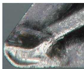
外部冷却液供给会导致过度的月牙洼磨损 (常规冷却压力)
