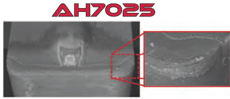
加工 60 件后的刀具磨损
