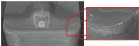
加工 60 件后的刀具磨损
