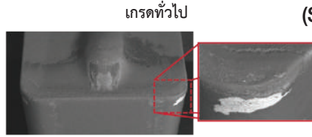
รอยสึกหลังจากทำการเซาะร่อง 30 ครั้ง
