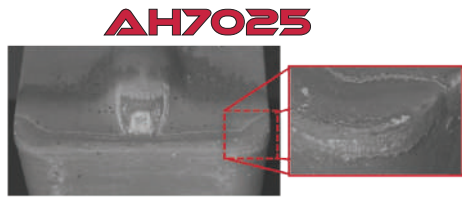
รอยสึกหลังจากทำการเซาะร่อง 60 ครั้ง
