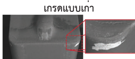
รอยการสึกหรอหลังจากเซาะร่อง 30 ครั้ง
