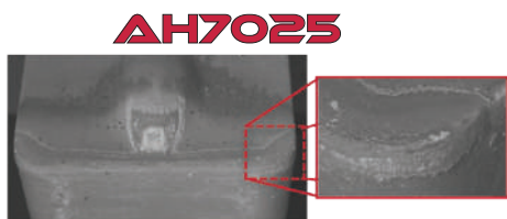
รอยการสึกหรอหลังจากเซาะร่อง 60 ครั้ง
