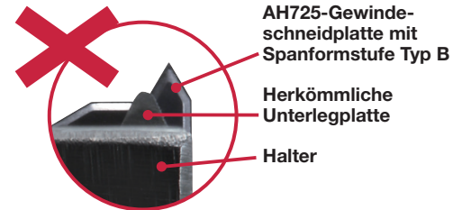
Beispiel für falsche Unterlegplatte
