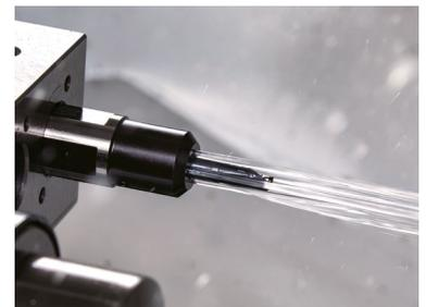
En combinaison avec le manchon à 4 trous d'arrosage, l'outil TBMFR07 offre une fiabilité d'usinage supérieure.
