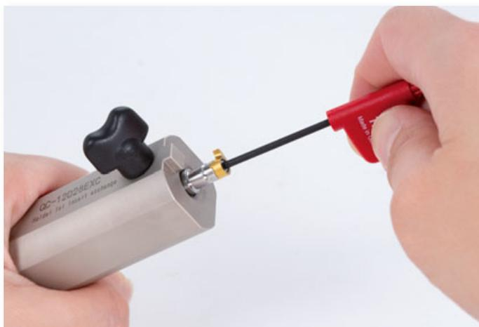
TinyInternalCut はヘッドサイズが小さいため、インサート交換が困難な場合は、交換を容易にするインサート交換用ホルダをご使用ください。
