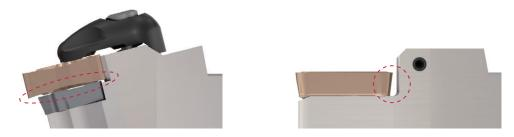
请注意: 只要刀片正确定位在刀垫/刀杆上的导轨定位槽, 这个间隙是没有问题的。
