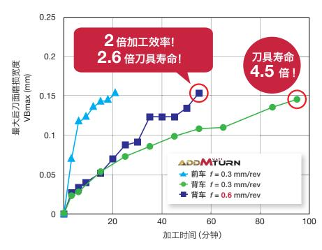
当使用相同的进给速度进行背车加工时, AddMultiTurn单面刀片能够实现至少4.5倍的刀具寿命。 此外, 当使用双倍的进给速度时, AddMultiTurn能够实现至少 2.6倍的刀具寿命。 刀片 : 3C-TCMT29X608-TM
