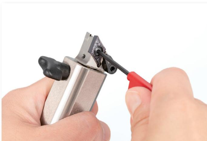
**ModuMini-Turn** 模块化刀头很小。当用手指握住模块化刀头难以更换刀片时，请使用专用支架以方便更换刀片。
