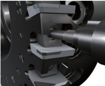
インサート取付 TORX ビット使用
