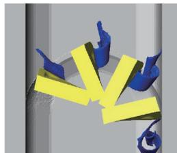
Durch die sehr gute Spanabfuhr werden die Nachbearbeitung und frühzeitiger Wendeschneidplattenausfall eliminiert.
