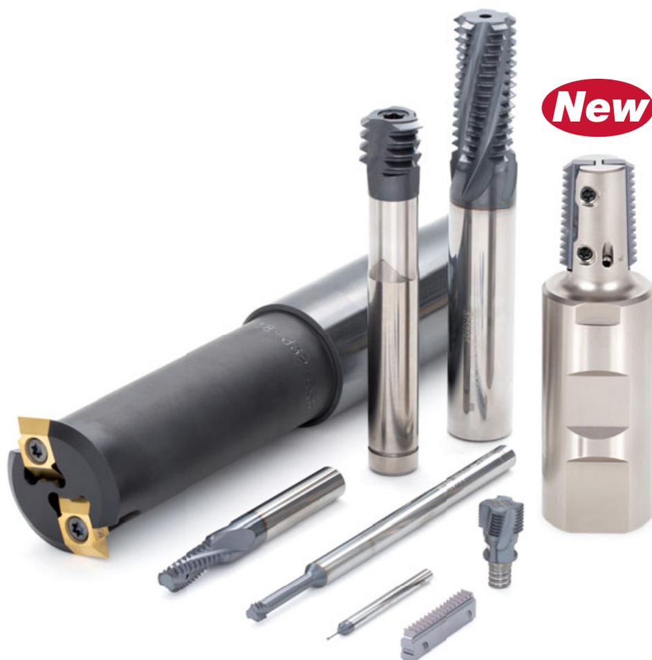
管用テーパねじ向け刃先交換式工具は、インサート交換のみで、R (BSPT おねじ)、Rc (BSPT めねじ)、NPT、NPTF の内外径ねじを、同一工具で加工可能
