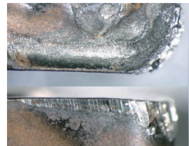
后刀面磨损的加剧会导致小崩刃和切屑粘附
