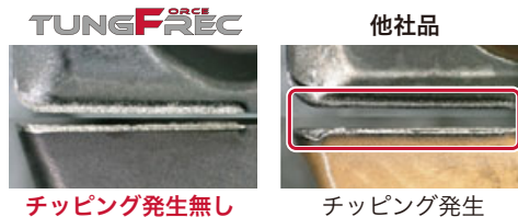
加工距離同等時の損傷状態
