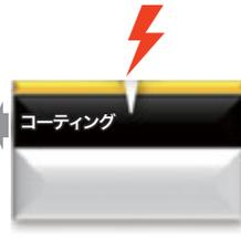
プレミアムテック技術により残留引張り応力を最適化し、クラックの進展を抑制する。
