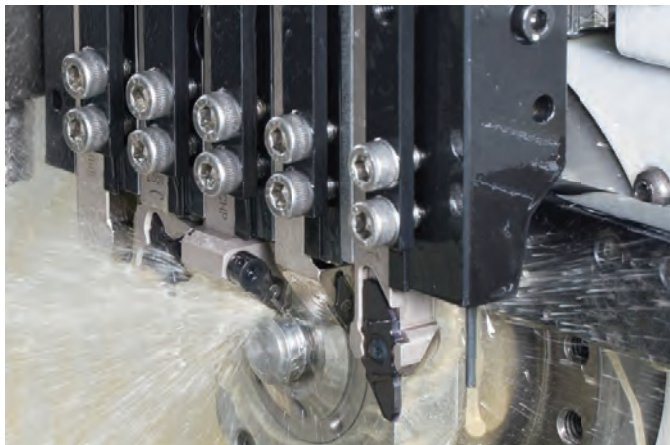
内部冷却液供冷
