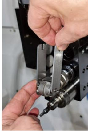
② コレットと工具をスピンドルに挿入した後、コレットを締め付けて工具を固定する。
