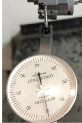
③ インジケータを使って、スピンドル本体の研削面と機械の平行度をチェックする。
