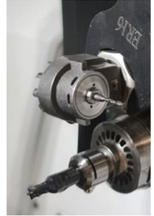
④ コレットナットを締め、TJS M90 アングルヘッドをホルダに固定する。
