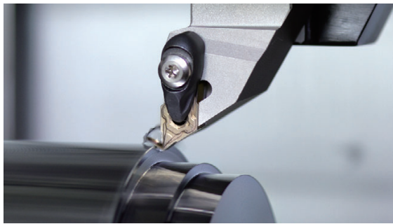
New FNMG type Corner angle: 45°
