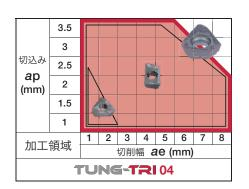
カッタ : EPA04R010M10.0-02 (ø10 mm, z = 2) インサート : TOMT040204PXER-MM AH3225
