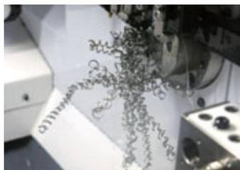
ワークや工具への切りくずの巻き込み解消
