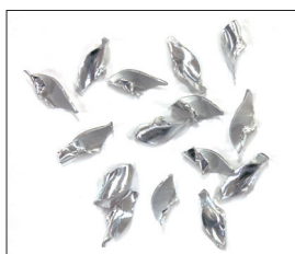
Alliage d'aluminium (A5052)
