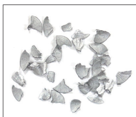
Alliage d'aluminium de fonderie (ADC12)
