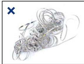
STX 形インサートは、排出溝により切りくずが絡むことなく流出方向の制御が可能。
