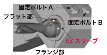
ドリルのフランジ部にあるフラット面の中心に、「EZスリーブ」端面側の目盛りを合わせます。右図は、ドリルの芯が  $+0.1 \text{ mm}$  移動するようにセットしています。
