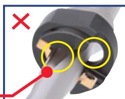
Les plaquettes sont mal situées à cause du mauvais positionnement de la bague
