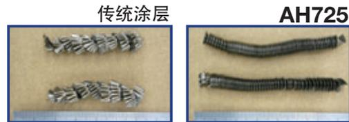
切屑形状卷曲自然，可得到稳定的加工表面（不锈钢加工）
