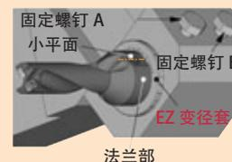
将钻头法兰部的小平面中心，对准EZ变径套端面上的刻度。右图为钻头中心正设置向+字方向移动0.1 mm。
