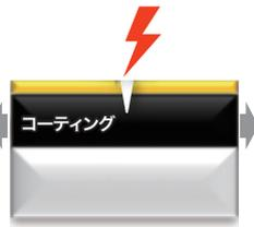
プレミアムテック技術により残留引張り応力を最適化し、クラックの進展を抑制する。
